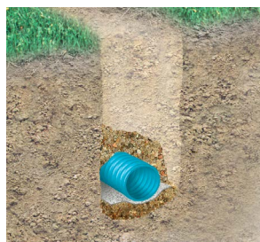
I lygio pavojus: po drena geotekstilės sluoksnis, iš viršaus - birus užpilas (žvyras)
