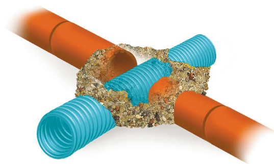
Naujos PVC drenos sujungimas su senąja keramike drena.
