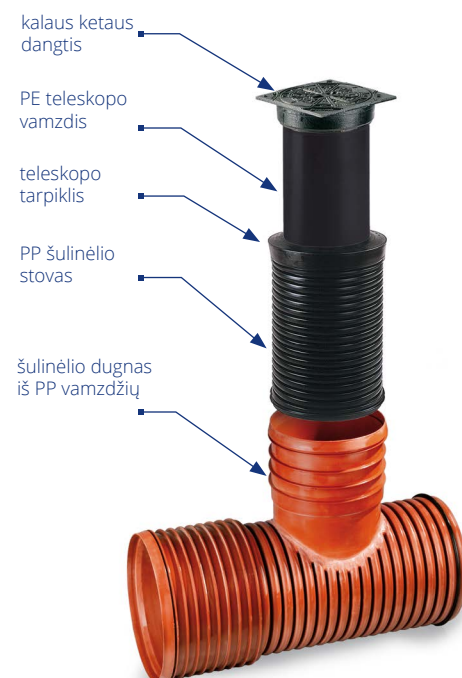
Pipelife šulinėlis su dugnu iš PP-B gofruoto dviguba siennele vamzdžio Pragma OD arba Pragma ID.
